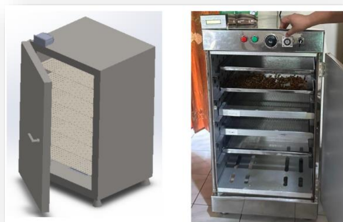
Gambar 3. 26 Desain alat Pengering Simplisia
